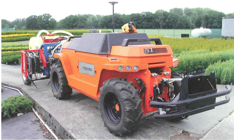
De Greenbot heeft vierwielaandrijving, een dieselmotor van 100 pk en veel hightech.
