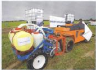
Het prototype van de robot-bemester met de autonome werkende Conveer Groenbodem erven. De bemester kan twee verschillende plaatsen in de aardoppervlakte toedienen.
