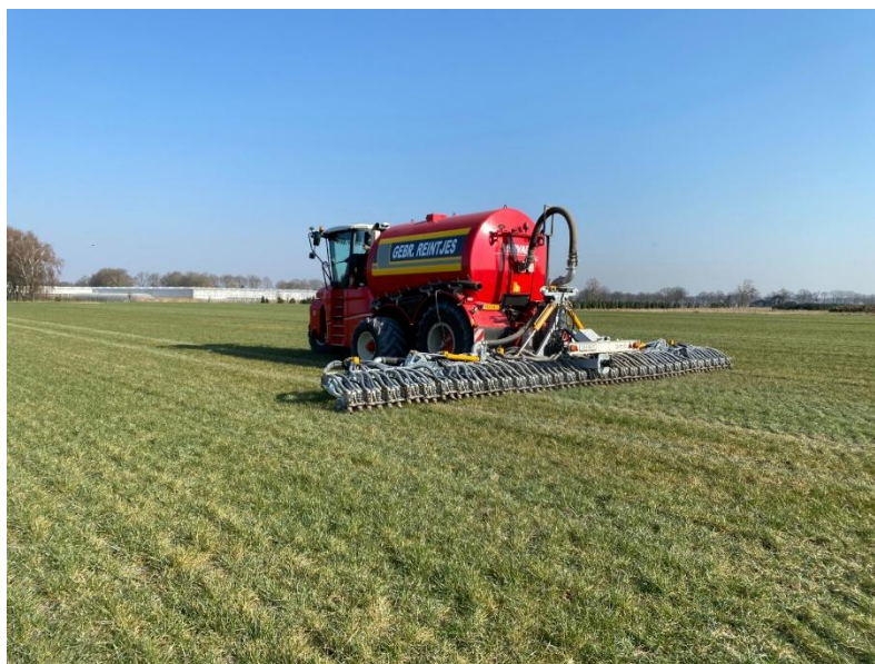
Foto : Precisiebemester voor de toediening van Mineralenconcentraat van fa Slootsmid
